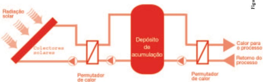
Figura 11 Sistema solar com armazenamento.
